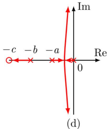
大致上讲，在开环传递函数中加入左半平面的零点具有使原来的根轨迹向左半平面推移的效果。
