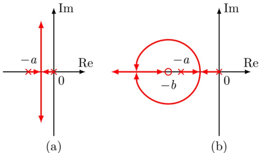
大致上讲，在开环传递函数中加入左半平面的零点具有使原来的根轨迹向左半平面推移的效果。
